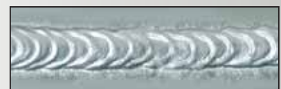
MIG PULSE ON PULSE welding on aluminium • Saldatura MIG PULSE ON PULSE su alluminio • Soudage MIG PULSE ON PULSE sur aluminium • Soldadura MIG PULSE ON PULSE en aluminio • Schweißen MIG PULSE ON PULSE auf Aluminium • Сварка MIG PULSE ON PULSE на алюминии
